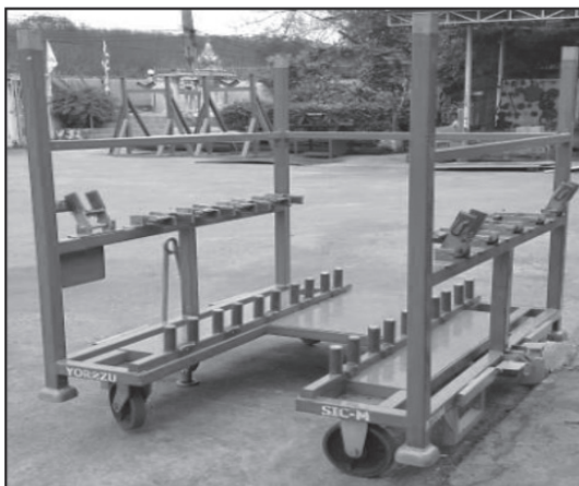
รูปที่ 4.3 รถเข็นสำหรับห้อยแขวนชิ้นส่วนรถยนต์รุ่น SIC-M
